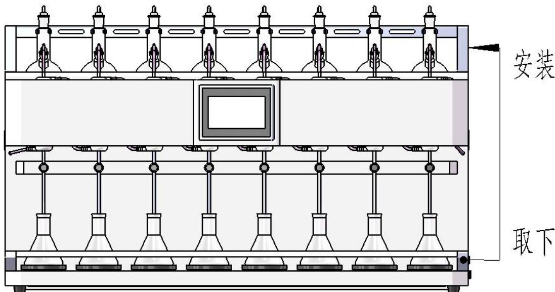
将进出水管连接冷水机，将废液管放入废液桶中（废液桶需用户自备，最好为聚乙烯桶，能耐高温）。
