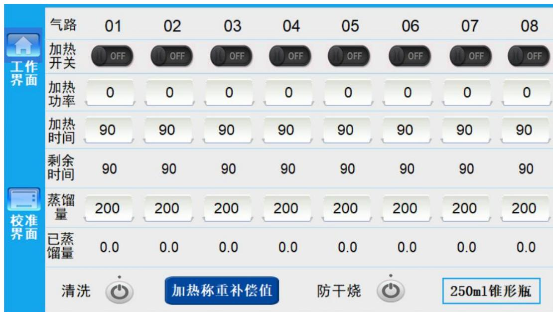
将待清洗通道对应锥形瓶中装入约 200mL 的纯水，然后将专用清洗接头插入对应通道的两口烧瓶 24#磨砂口上；点击“清洗”按钮，则清洗泵立即启动，将锥形瓶中的纯水抽吸到烧瓶中，从而清洗整个馏出液管路；待锥形瓶中的清水抽完后，关闭
