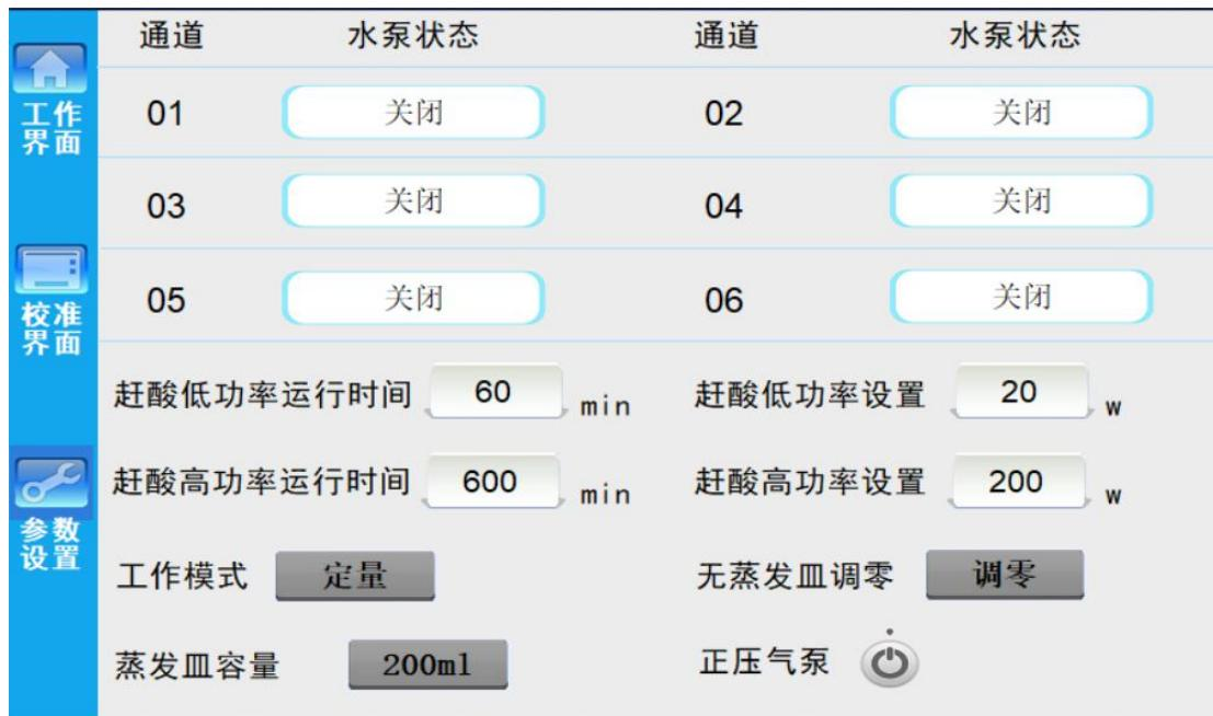
工作模式设置“定量”、“非定量”、“单次蒸干加热”模式的切换。“定量”模式时，水样总量设置有效；“非定量”模式时，水样总量设置无效，直到把水样抽干才停止工作；“单次蒸干加热”模式，适用于做溶解性总固体等不需要自动添加溶液，只需要将 100ml 左右的溶液蒸发完全的项目，开启这个模式后，点击加热开关，仪器不自动添加样品，只将蒸发皿中的溶液蒸干后停止加热，加热前应先将装有溶液的蒸发皿放置在相应加热位。
