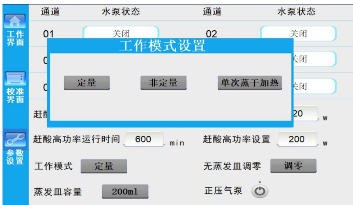
“蒸发皿容量”选择按钮可以选择 200ml、125ml 两种规格的蒸发皿。
